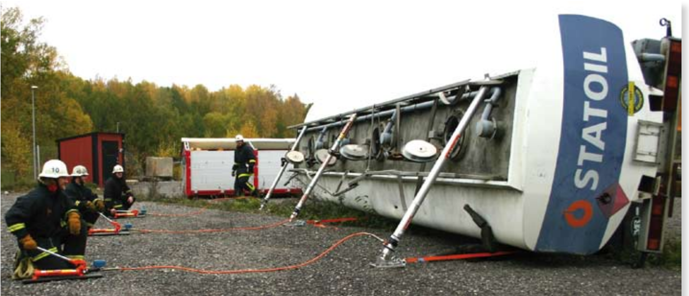
A nehéz járművek alátámasztása és emelése hidraulikus PowerShore™ rendszerrel
