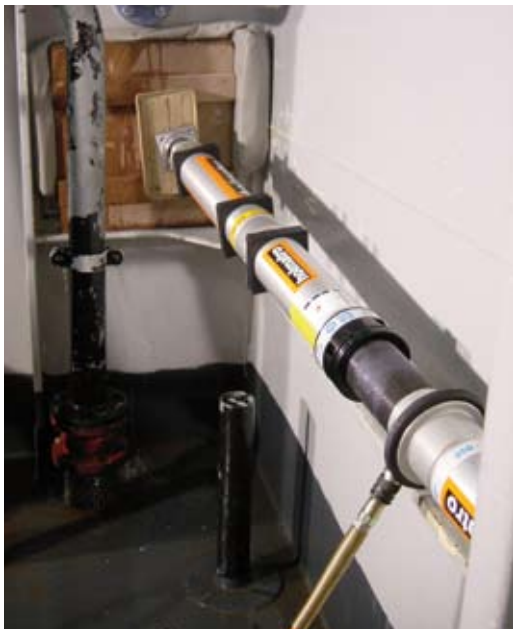
Elválasztó panelek szigetelése a raktérben hidraulikus PowerShore™ tengerészeti kárelhárító készlettel.
