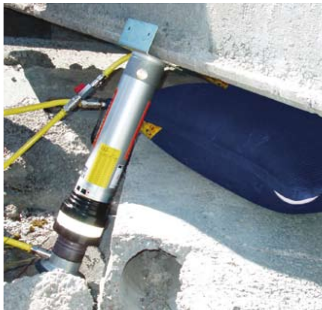
Önzáró „Auto-lock” támhenger alkalmazása emelőpárnával
