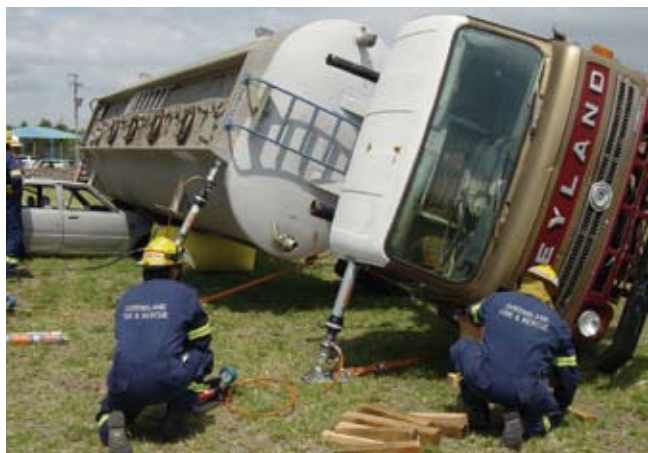
Hidraulikus önzáró „Auto-lock” támhenger, alkalmazása nehéz jármű emelésére és támasztására.
