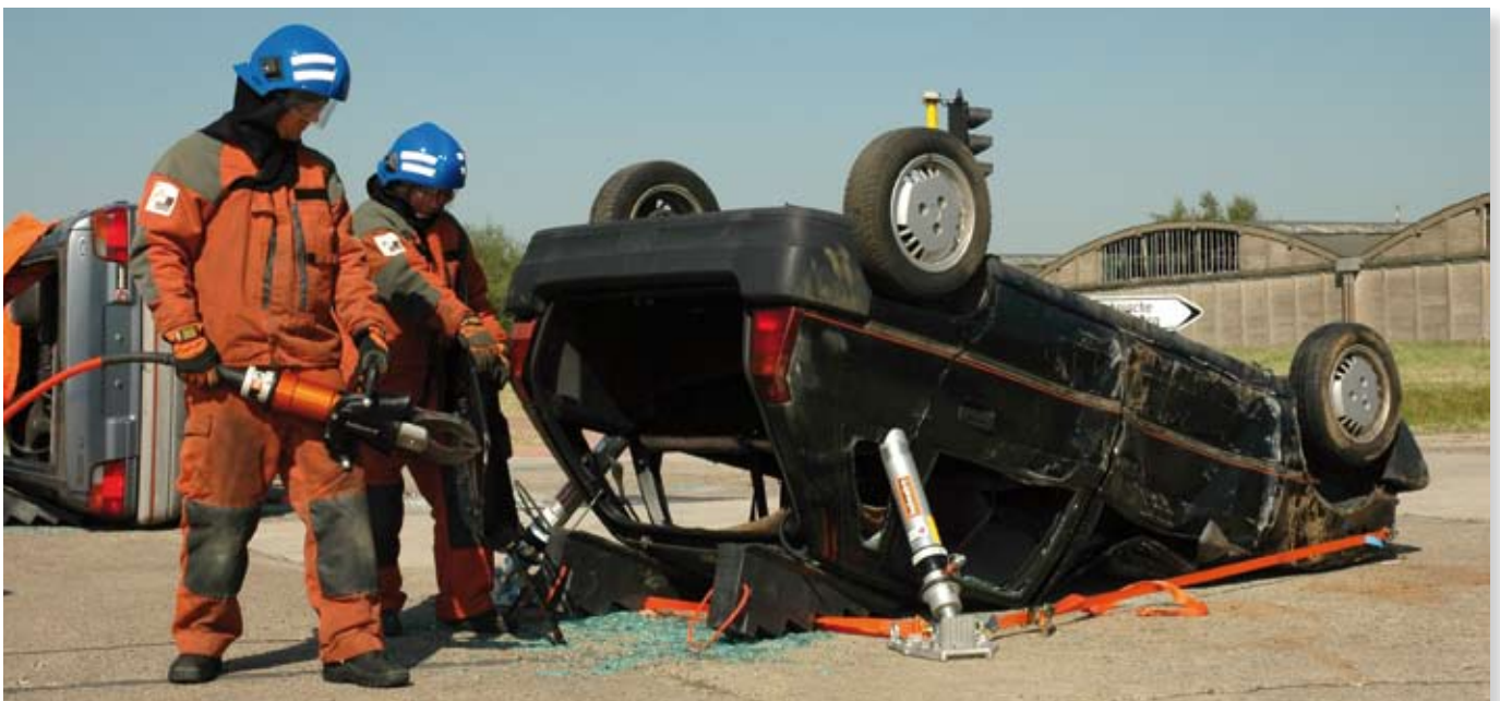
Kettő hidraulikus támhenger használtnak könnyű járművek stabilizálására, és ha szükséges az emelés kontrollálására
