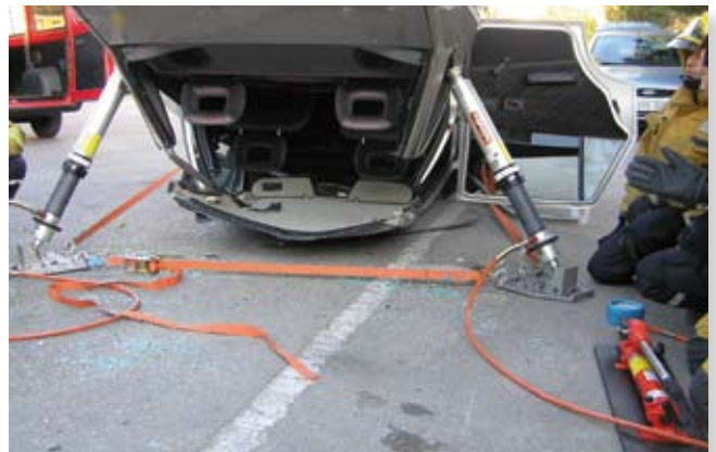
Könnyű járművek stabilizálása hidraulikus „Locknut” rögzítőanyás támhengerekkel
