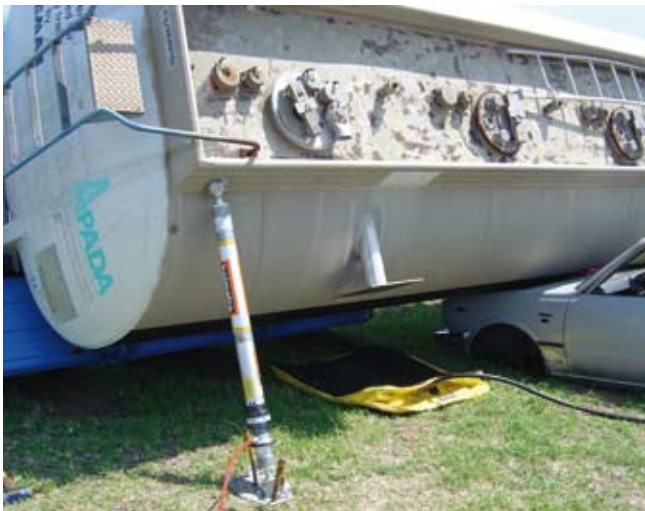
Pneumatikus önzáró „Auto-lock” támhenger használta nehéz járművek emeléséhez, mint „követő támasz”
