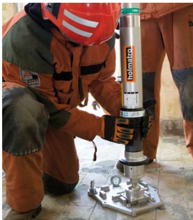
Pneumatikus rögzítőanyás „Locknut” támhenger, alkalmazása, mint kézi támhenger építménynél.
