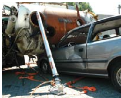
Könnyű járművek stabilizálása hidraulikus „Locknut” rögzítőanyás támhengerekkel
