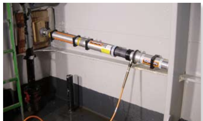
Hidraulikus támhengereket hosszabbítókkal, fejekkel és fa gerendával, egy lyuk szigetelésénél egy tengeri hajónban.
