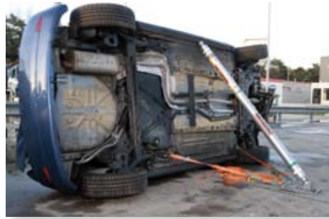
Könnyű jármű stabilizálása hosszabbítók, feje és alaplap használatával.
