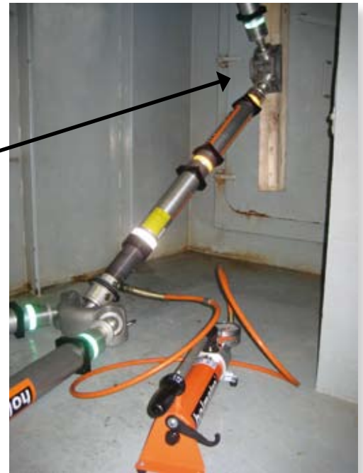
3-as forgófej, és 2-es blokk, alkalmazása különböző irányú támasztási vonalakhoz.
