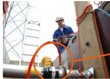
Az Auto-lock rendszer alkalmas távolról kitémasztásra
