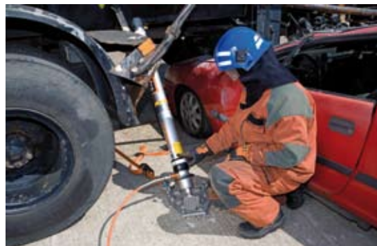
Nehéz járművek stabilizálása hidraulikus rögzítőanyás „Locknut” támhengerrel
