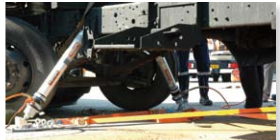
Nehéz járművek stabilizálása hidraulikus rögzítőanyás „Locknut” támhengerrel
