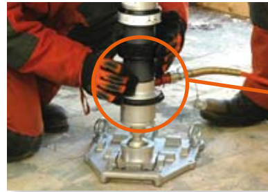
Az alátámasztandó teher biztosítása kézi „Locknut” rögzítőanyával
