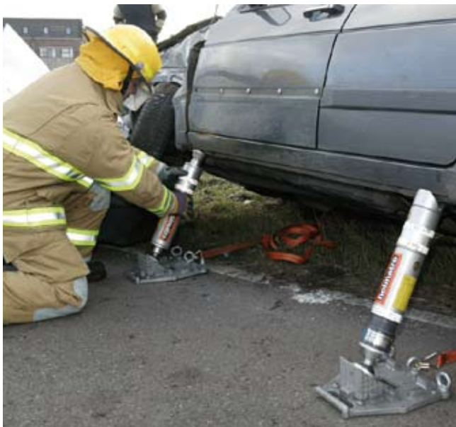
Járműstabilizálás rögzítőanyás „Locknut” támhengerrel
