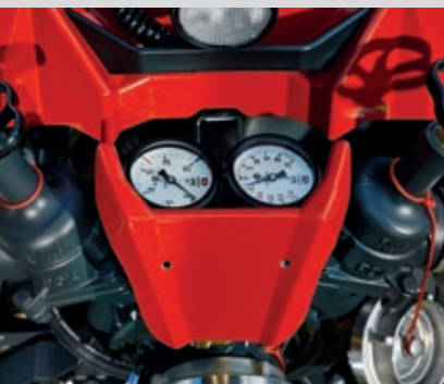
Übersichtliche und geschützte Anordnung der Manometer
