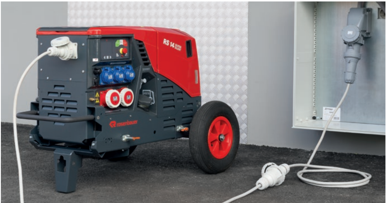
RS 14 mit Verbindungsleitung zur Einspeisevorrichtung am Objekt
