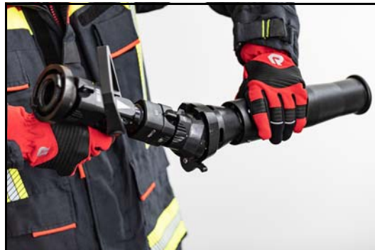
Szerelje fel a habfeltétet a sugárcsőre
